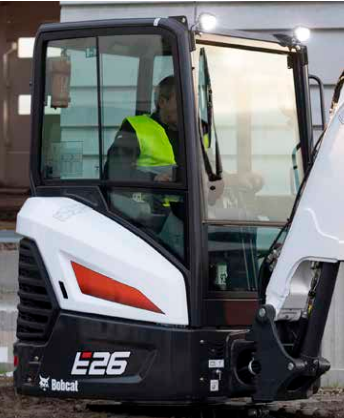
Kabina TOPS/ROPS/FOPS z ogrzewaniem
