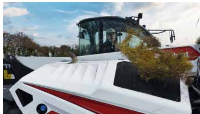
Układ zmiany kierunku obrotów wentylatora z trybami ręcznymi i automatycznymi
