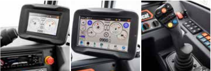
Standardowy wyświetlacz 5-calowy z radiem z Bluetooth, mikrofonem i głośnikami Wyświetlacz 7-calowy (radio z Bluetooth, mikrofon i zarządzanie zadaniami) Inteligentny joystick
