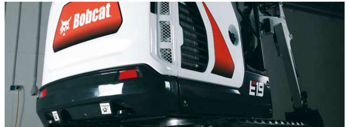
Odlewana przeciwwaga chroni tylną klapę
