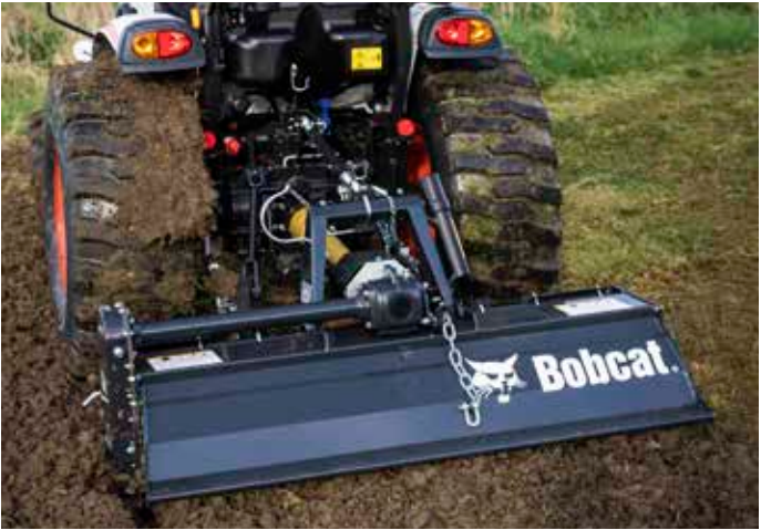
Tylny WOM z optymalizowanymi obrotami 540 obr/min, zapewniający maksymalną wydajność i łączliwość – standard we wszystkich modelach.
