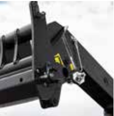
Hydrauliczna blokada osprzętu przy użyciu osobnej linii pomocniczej
