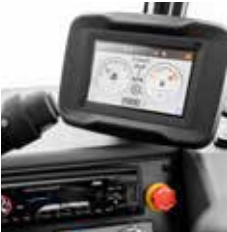
Standardowy wyświetlacz 5-calowy z radiem z Bluetooth, mikrofonem i głośnikami
